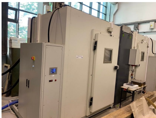
Fot. 5. Komora klimatyczna znajdująca się na hali budynku A Politechniki Świętokrzyskiej.
