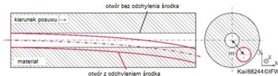
Rys. 11. Odchylenie osi wywierconego otworu [44]
