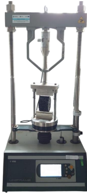
Rys. 4.13. Prasa wytrzymałościowa do określenia wytrzymałości na pośrednie rozciąganie próbek z zestawu suchego i mokrego (ITSR)
