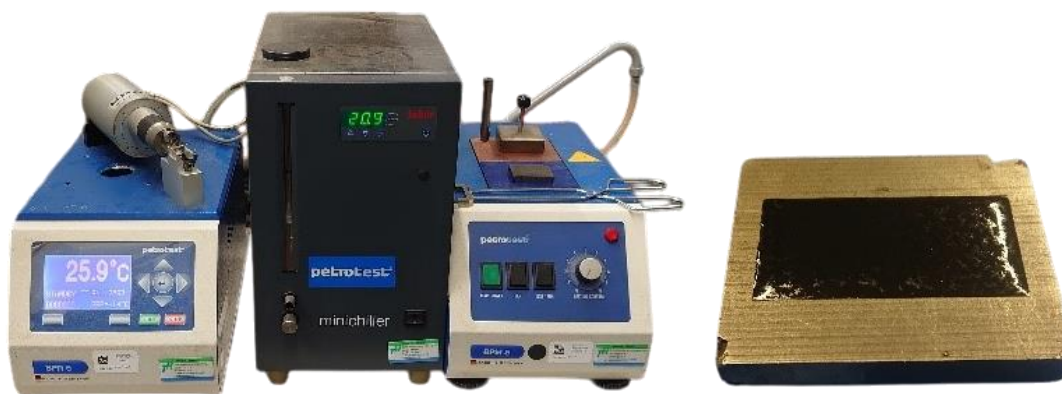
Rys. 4.4. Aparatura testowa wykorzystana do określenia temperatury łamliwości wg Fraassa (z lewej), próbka asfaltu przygotowana do badania (z prawej)
