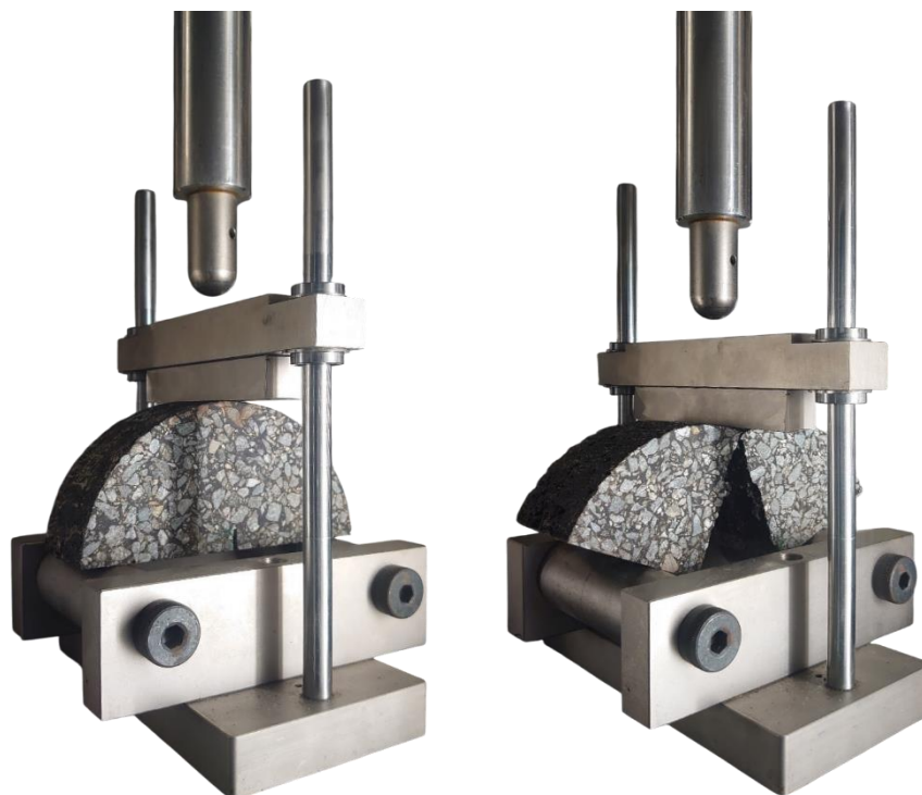
Rys. 4.14. Propagacja pęknięcia w badaniu zginania próbki półwalcowej. Próbką przed badaniem (po lewej) i po badaniu (po prawej)
