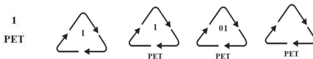
Rys. 3.5. Wzory oznakowania których można użyć do oznaczenia opakowań z PET wg Rozporządzenia Ministra Środowiska [74]
