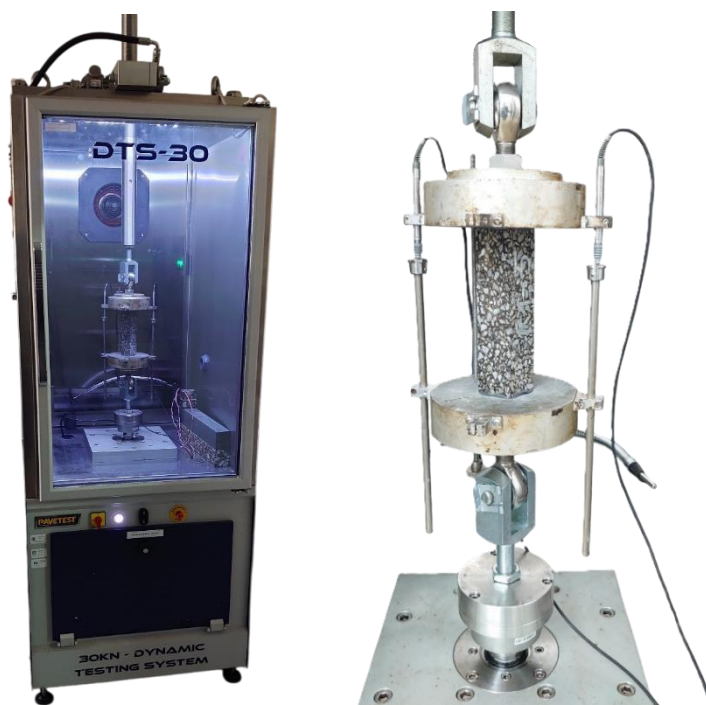
Rys. 4.17. Badanie odporności próbek na naprężenia termiczne metodą TSRST (aparatura testowa - z lewej, schemat obciążenia – z prawej)
