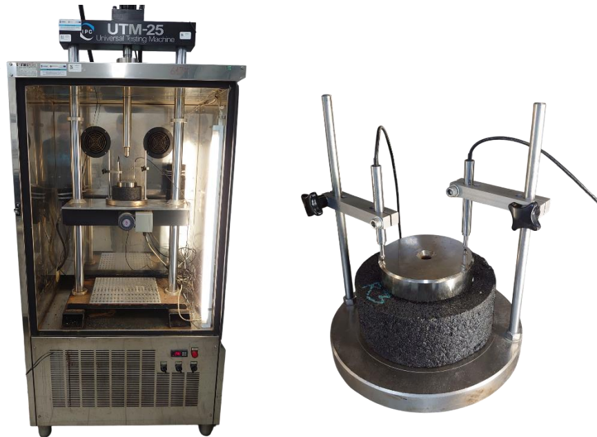
Rys. 4.16. Badanie jednoosiowego ściskania ze skrępowaniem bocznym (aparatura testowa - z lewej, schemat obciążenia – z prawej)
