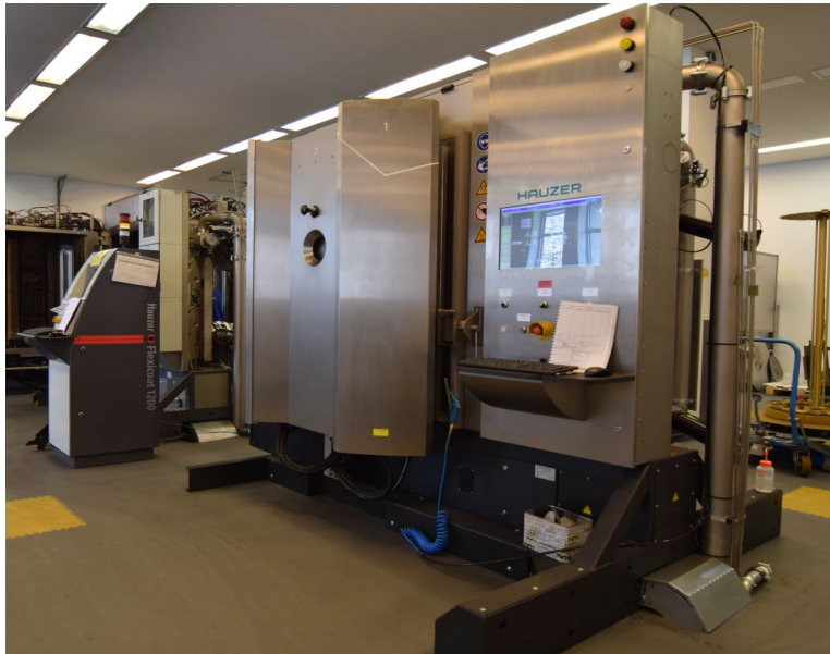
Rys. 6.5. Urządzenie do nakładania powłok DLC Hauser Flexicoat 1200
