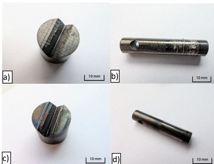
Rys. 9.26. Wygląd próbek do testera T-09 po testach tribologicznych: a) próbka z powłoką DLC teksturowaną laserowo, b) przeciwpróbka z powłoką DLC teksturowaną laserowo, c) próbka z powłoką DLC bez tekstury, d) przeciwpróbka z powłoką DLC bez tekstury
