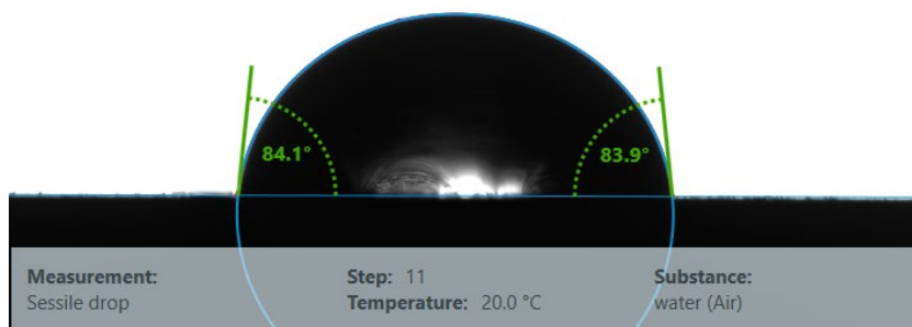
Rys. 9.31. Kąt zwilżania wodą powłoki DLC bez tekstury
