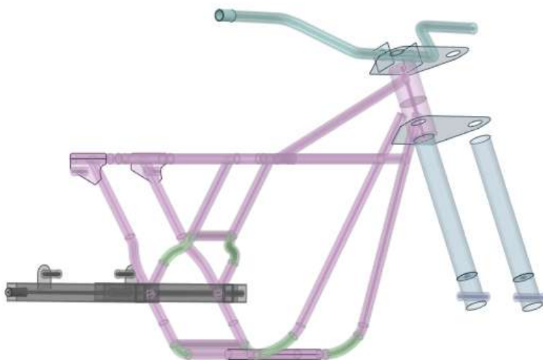
Rys. 10.6 Model motocykla Yamaha XV 125 zaimportowany do środowiska LS-DYNA
