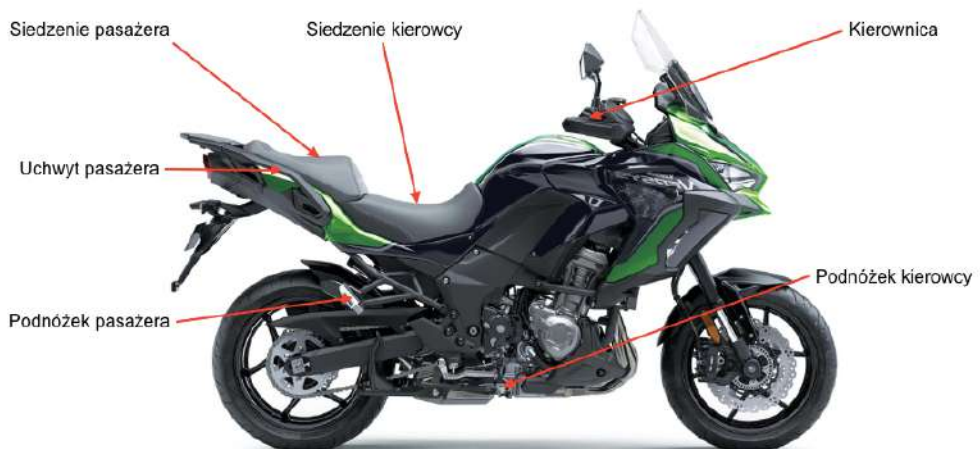
Rys. 1.3 Elementy motocykla przenoszące drgania na kierowcę oraz pasażera [8]
