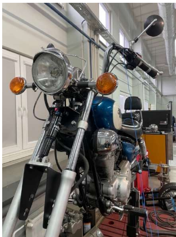
Rys. 9.2 Zmodyfikowane zawieszenie przednie w motocyklu Yamaha XV 125
