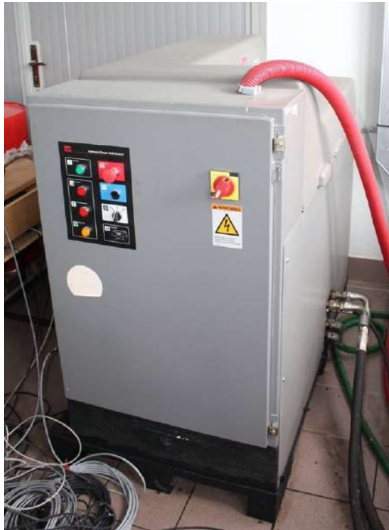
Rys. 7.6 Zespół zasilania hydraulicznego Model Silent flow 505.20.
