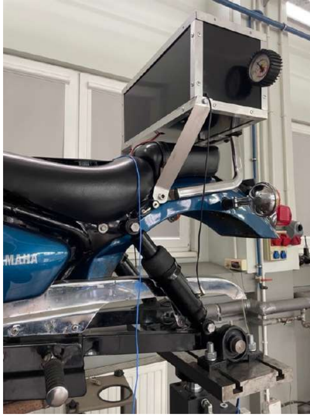
Rys. 9.1 Zmodyfikowane zawieszenie tylne w motocyklu Yamaha XV 125
