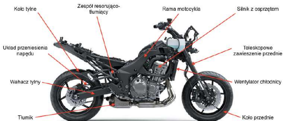
Rys. 1.4 Elementy motocykla generujące oraz przenoszące drgania z nawierzchni drogi [8]
