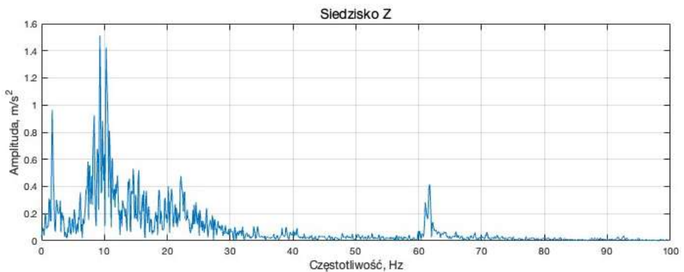
Rys. 6.14 Widma amplitudowe przyspieszeń drgań zarejestrowanych w osiach X, Y i Z na siedzisku motocykla podczas przejazdu drogą z nawierzchnią asfaltową o złym stanie technicznym przy prędkości 50 km/h
