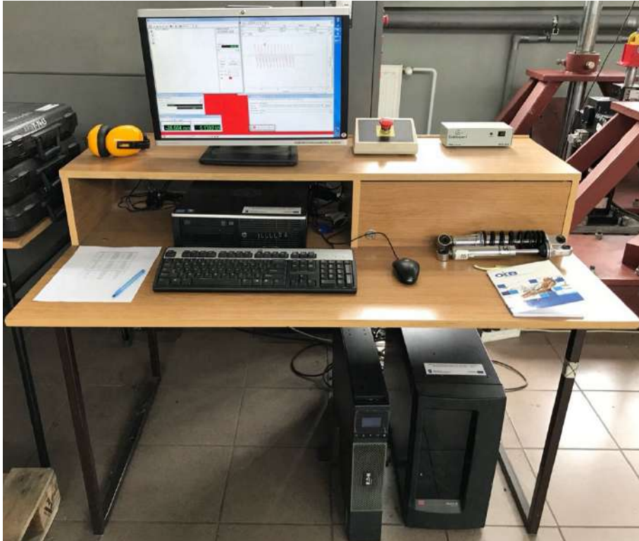
Rys. 7.7 Stanowisko kontrolno-sterownicze z oprogramowaniem firmy MTS Series 793 Control Software oraz Moog Replication
