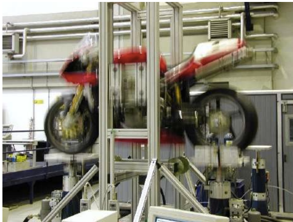
Rys. 4.2 Motocykl podczas badania na symulatorze BikeShake [74]
