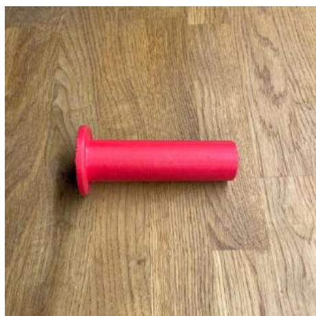
Rys. 9.3 Manetki wykonanych w technologii druku 3D a – Fiberlogy 40D, b – RosaFlex96A
