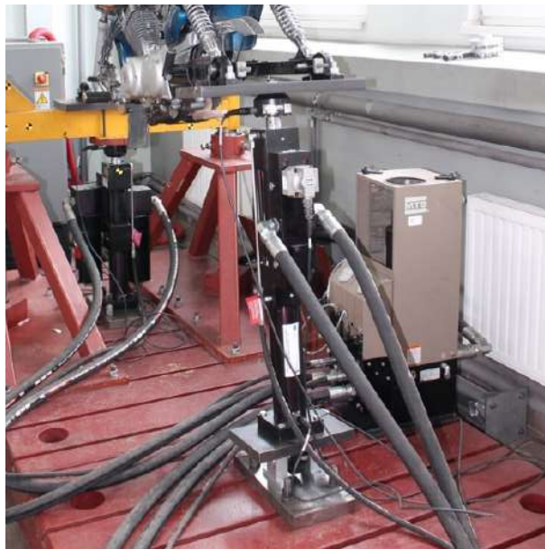
Rys. 7.3 Pulsator elektrohydrauliczny wraz z przegubem i płytą umożliwiającą montaż wahaczy motocyklowych
