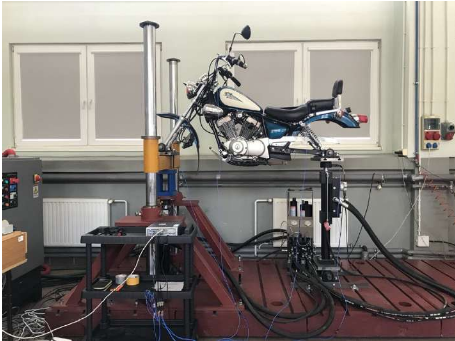
Rys. 7.1 Stanowisko badawcze do symulacyjnych badań pojazdów jednośladowych
