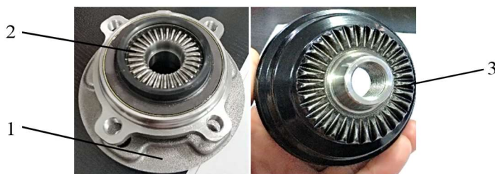
Rys. 8. Łożysko piasty trzeciej generacji z wykonanym uzębieniem na czole kołnierзовego pierścienia wewnętrznego. Zdjęcie po prawej przedstawia kielich półosi. 1 – kołnierзовy pierścień zewnętrzny, 2 – kołnierзовy pierścień wewnętrzny z wieniem zębatym, 3 – kielich półosi z wieniem zębatym [24]
