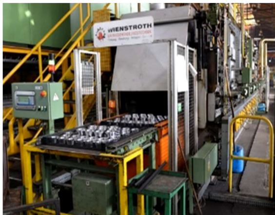
Rys. 17. Linia do hartowania i odpuszczania firmy Wienstroth
