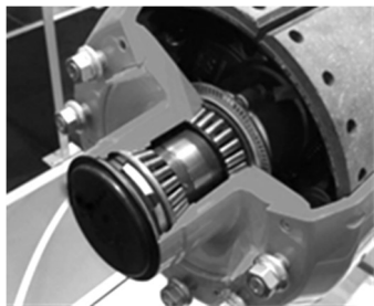
Rys. 1. Przykład rozwiązania konstrukcyjnego łożyskowania piasty koła jezdnej za pomocą dwóch łożysk stożkowych [24]
