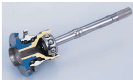
Rys. 9. Łożysko piasty czwartej generacji - kombinacja łożyska piasty trzeciej generacji z przegubem homokinetycznym [26,27]
