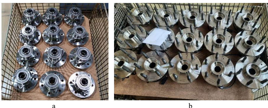
Rys. 121. Zmontowane zespolone piasty łożyskowe trzeciej generacji: a) przed zawalcowaniem kołnierza, b) przygotowane do pakowania
