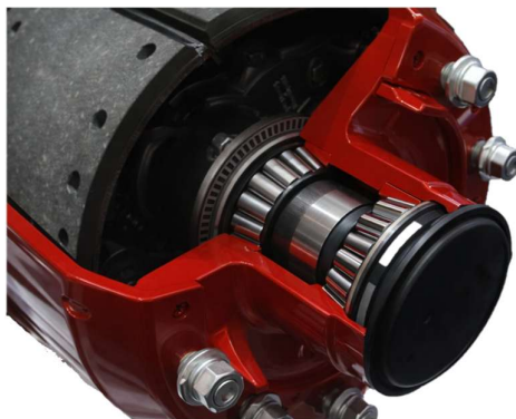
Rys. 1. Zespół dwóch łożysk stożkowych piasty koła naczepy samochodu ciężarowego [5]
