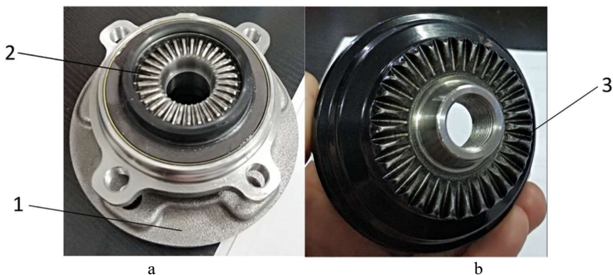
Rys. 6. a) Zespólona piasta łożyskowa trzeciej generacji z wielowypustowym mechanizmem sprzęgającym, b) kielich półosi: 1 – kołnierzowy pierścień zewnętrzny, 2 – kołnierzowy pierścień wewnętrzny z wieńcem zębatym, 3 – kielich półosi z wieńcem zębatym [5]
