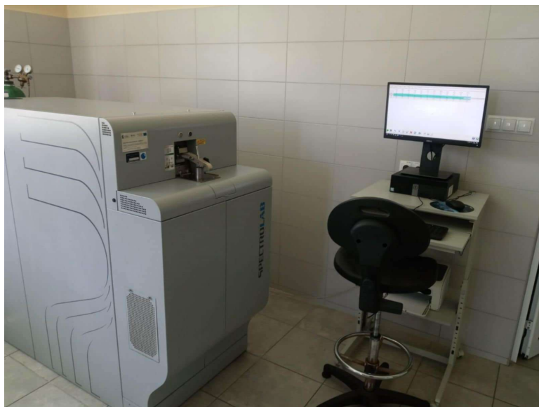
Rys. 46. Spektrometr SPECTROLAB LAVM12
