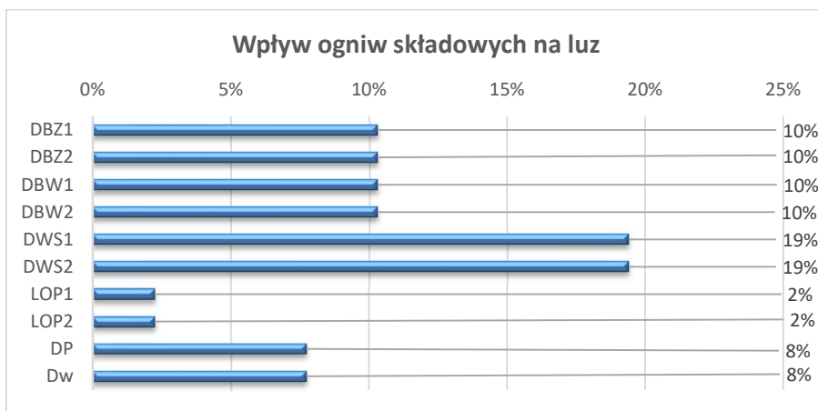
Rys. 25. Wykres procentowego wpływu ogniów składowych na luz wzdłużny – metoda jednakowej tolerancji
