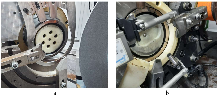
Rys. 55. Widok podpór oraz elektromagnetycznego oporu, a) obrabiarka 3MZEY1320, b) obrabiarka 3MZE2320
