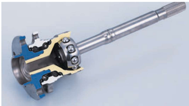
Rys. 7. Zespólona piasta czwartej generacji [69]
