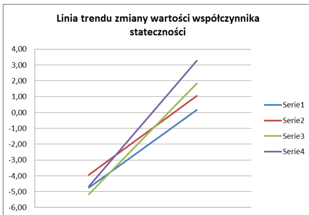
Ryc. 21. Linie trendu zmiany wartości współczynnika stateczności dla – Pd, I D = 0,50, przy wysokości nasypu 8,0m
