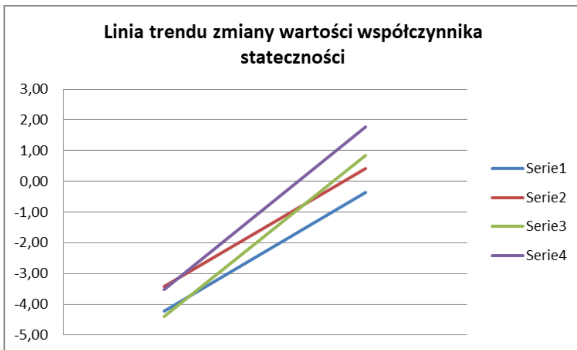
Ryc.56. Linie trendu zmiany wartości współczynnika stateczności dla – Ps, I_D = 0,65 , przy wysokości nasypu 5,0m
