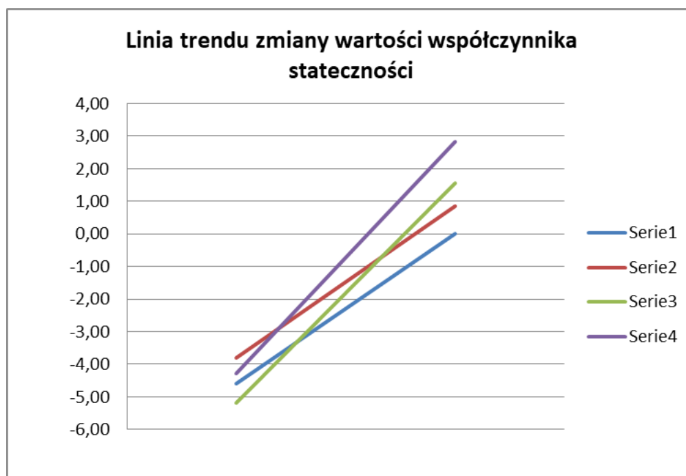
Ryc.26. Linie trendu zmiany wartości współczynnika stateczności dla – Pd, I D = 0,65, przy wysokości nasypu 5,0m
