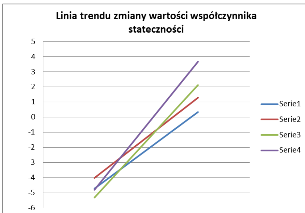
Ryc. 11. Linie trendu zmiany wartości współczynnika stateczności dla – Pd, I D = 0,35, przy wysokości nasypu 8,0m
