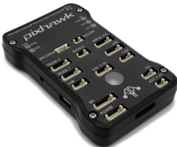
Zdj. 3.1. Kontroler Pixhawk w wersji FMUv2 [źródło własne]
