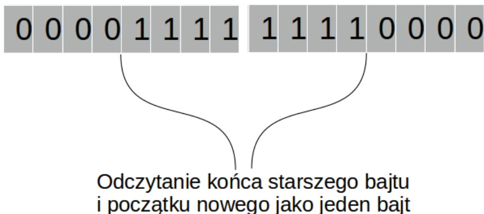
Rys. 5.5. Możliwe przesunięcie bitowe prowadzące do błędnego rozpoznania bajtu startowego [źródło własne]
