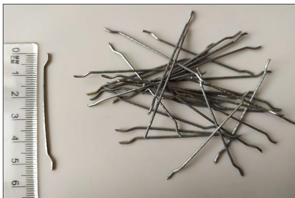
Rys. 2.17 Włókna stalowe stosowane do nawierzchniowego betonu cementowego [fot. K. Janus].
