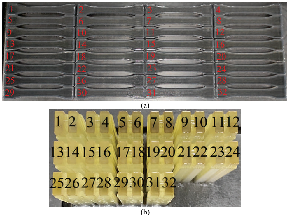
Rys. 6.7. Ułożenie próbek na platformie roboczej wykonanych technologią PJM: (a) kierunek wydruku 0^\circ , (b) kierunek wydruku 90^\circ
