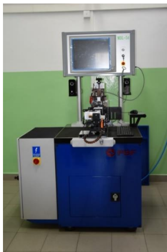
Rys. 46. System do pomiaru poziomu drgań MDL-54: a) projekt, b) widok rzeczywisty.
