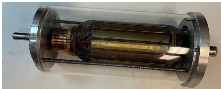
Rysunek 6.7: Wirnik silnika A w obudowie z tworzywa sztucznego - wyznaczanie momentu oporowego łożysk
