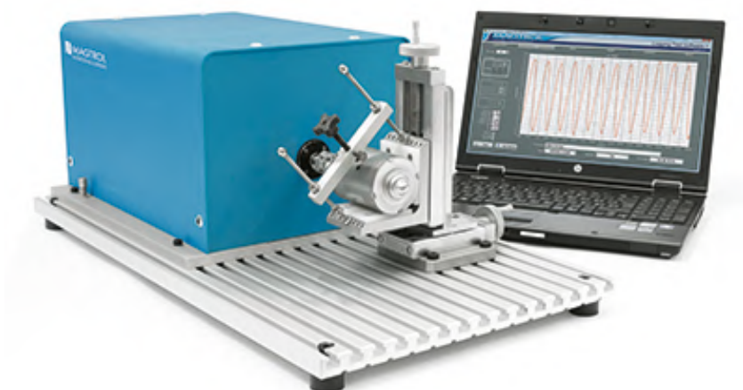
Rysunek 5.2: Przyrząd do pomiaru momentu zaczepowego CTS firmy Magtrol [60]
