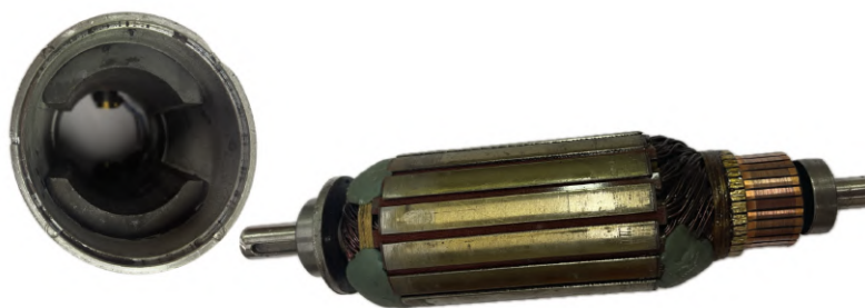
Rysunek 6.2: Model fizyczny wirnika i stojana badanego silnika
