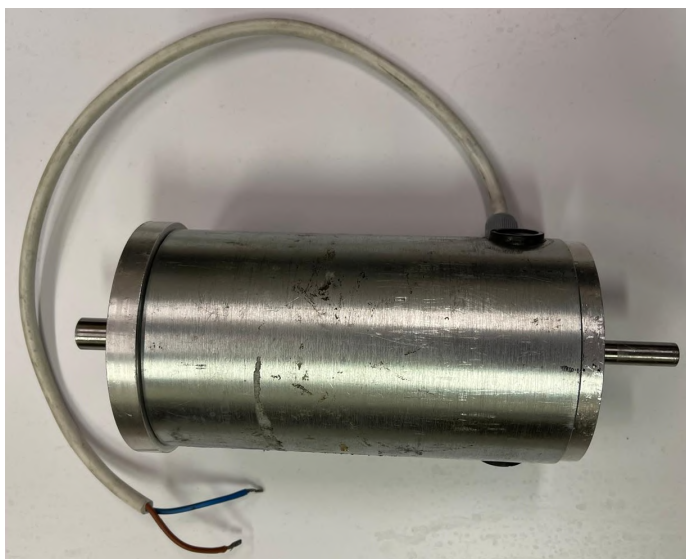
Rysunek 6.9: Prototyp silnika z magnesami prostopadłościennymi NdFeB
