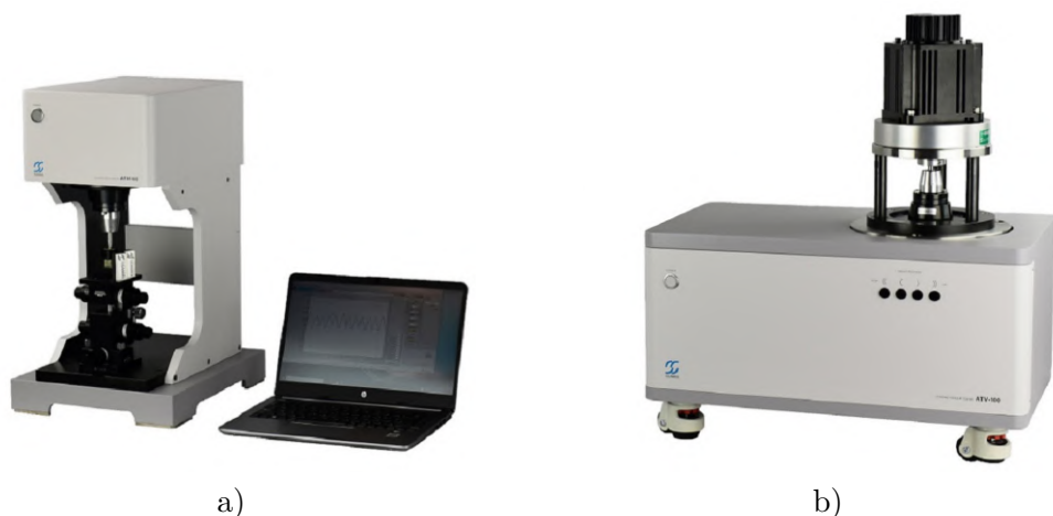
Rysunek 5.1: Przyrządy do pomiaru momentu zaczepowego firmy Sugawara Laboratories Inc. a) ATM-100 b) ATV-100 [97]
