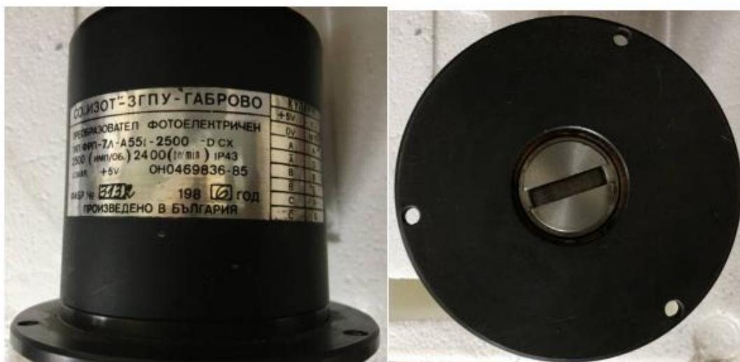
Rys. 12. Widok przetwornika (bok i od strony mocowania)
