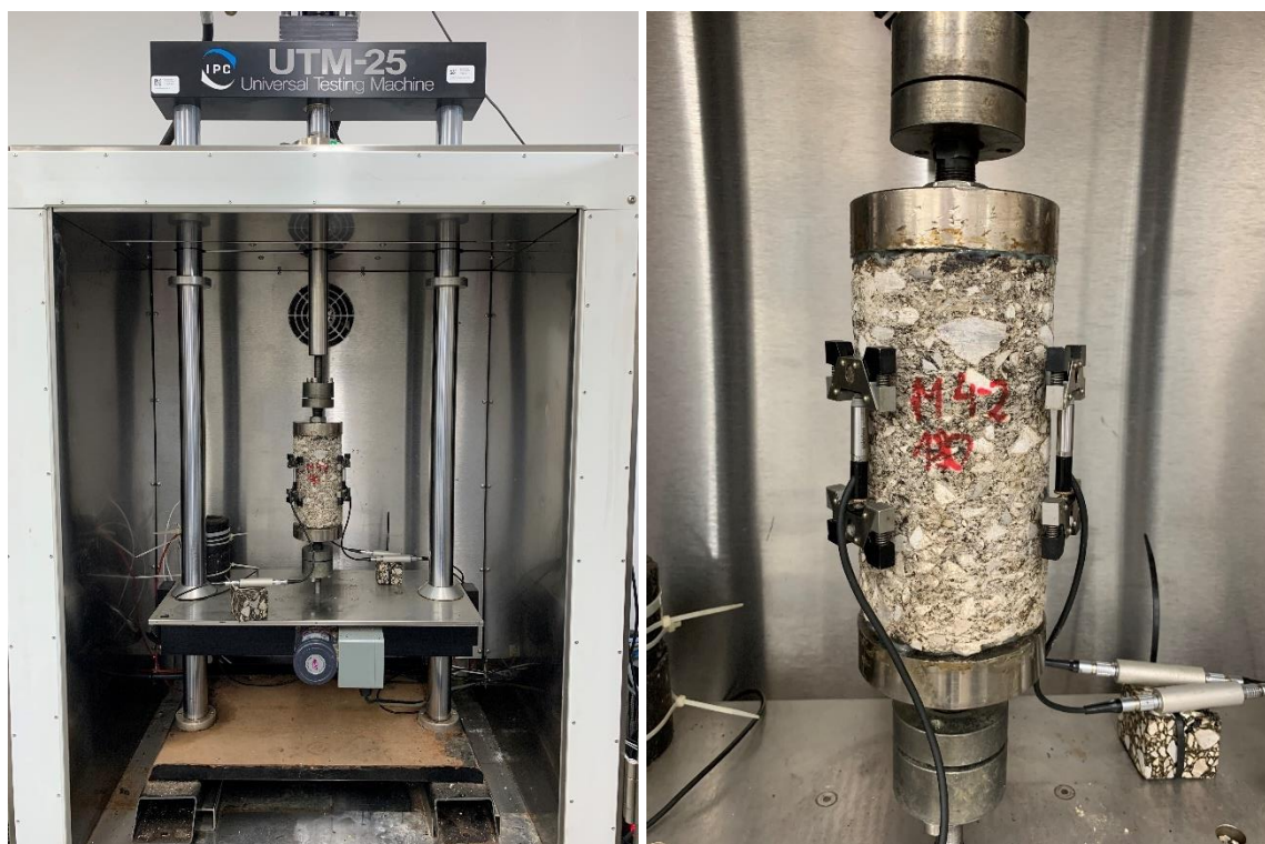
Rys. 6.31. Próbką w badaniu modułu zespolonego w układzie DTC-CY [Krasowski J.]
