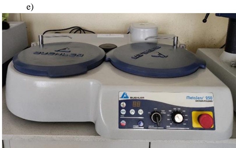
Rysunek 6.6. Urządzenia do przygotowania i kontroli próbek metalograficznych: a) przecinarka CLD TopTech, b) prasa do inkludowania BuehleSimpliMet 3000, c) szlifierko-polerka BuehlerAutoMet 250, d) mikroskop metalograficzny Innovatest, e) szlifierka BuehlerMetaServ 250 (opracowanie własne)
