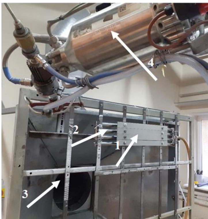
Rysunek 6.5. Stanowisko do natryskiwania zimnym gazem; 1 – próbki, 2 – system chłodzenia, 3 – wyciąg, 4 – nagrzewnica (opracowanie własne)
