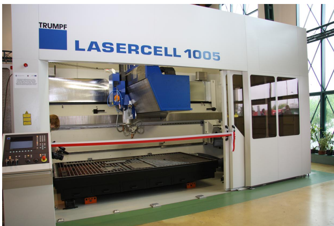
Rysunek 6.2. System laserowy TruLaserCell 1005 [99]
