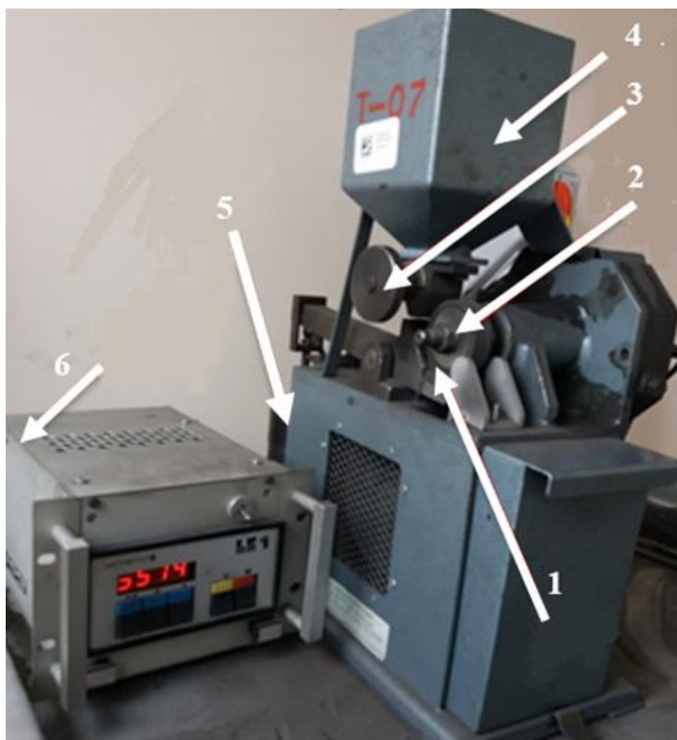
Rysunek 6.19. Tester T-07; 1 – próbka, 2 – gumowa rolka, 3 – regulacja prędkości podawania ścierniwa, 4 – zasobnik ścierniwa, 5 – obciążenie próbki, 6 – panel kontrolny (opracowanie własne)
