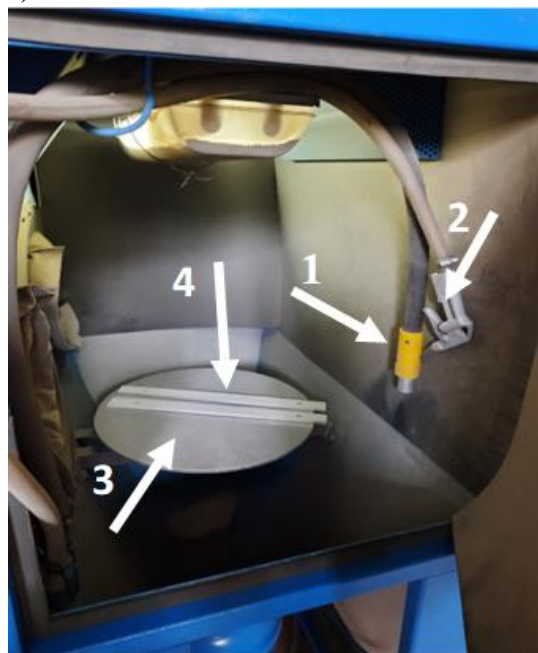
Rysunek 6.4. a) Urządzenie do obróbki strumieniowo-ściernej NEWTECH, b) Wnętrze komory; 1 – dysza, 2 – pistolet do sprężonego powietrza, 3 – stół obrotowy, 4 – próbki (opracowanie własne)
