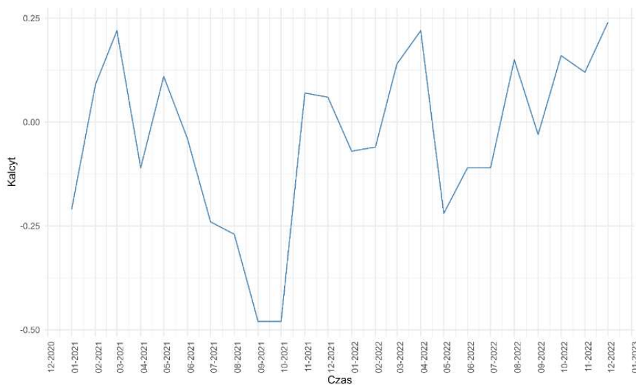
Rys. 9.180. Indeksy stabilności chemicznej kalcytu w czasie 24 miesięcy dla drugiego punktu poboru – Wola Kopcowa
