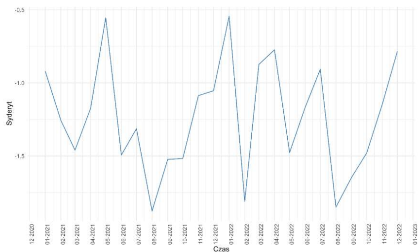
Załącznik 19 Indeksy stabilności chemicznej kalcytu w czasie 24 miesięcy dla ujęcia Wola Kopcowa
