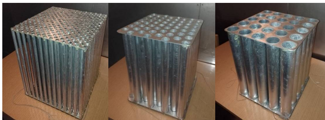
Rys. 34. Wymiennik ciepła 1 - cylindry 10 mm x 1mm. Rys. 35. Wymiennik ciepła 2 - cylindry 25 mm x 1 mm. Rys. 36. Wymiennik ciepła 3 - cylindry 40 mm x 1 mm.
