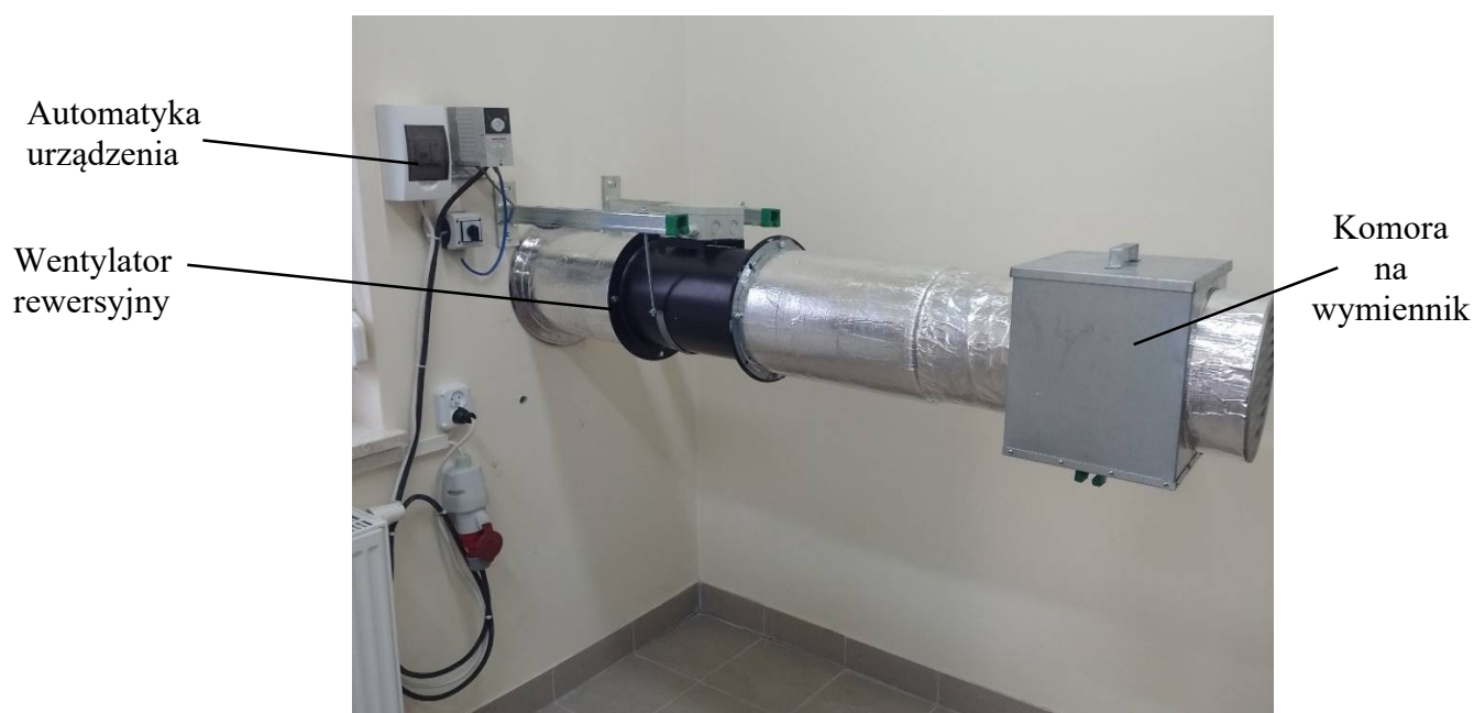
Rys. 45. Urządzenie do wentylacji fasadowej (widok od strony symulującej warunki środowiska wewnętrznego).
