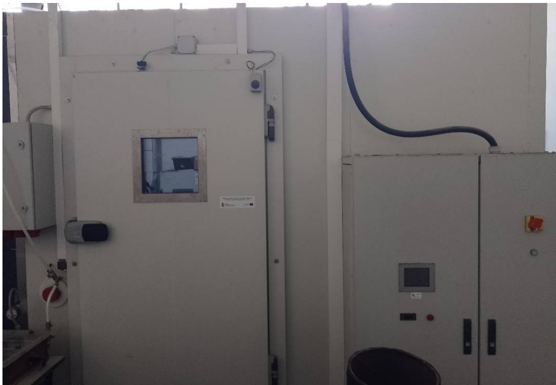
Rys. 30. Komora klimatyczna – część prawa symuluje warunki środowiska zewnętrznego.
