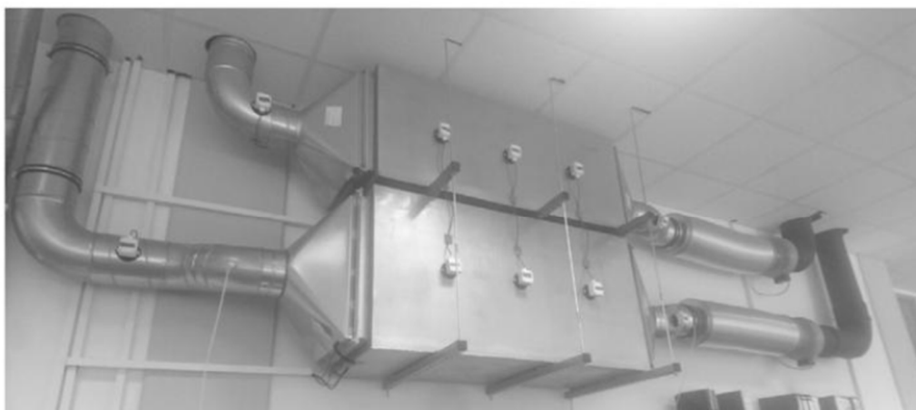
Rys. 4. Eksperymentalna konfiguracja systemu wentylacji z PCM 32 .
