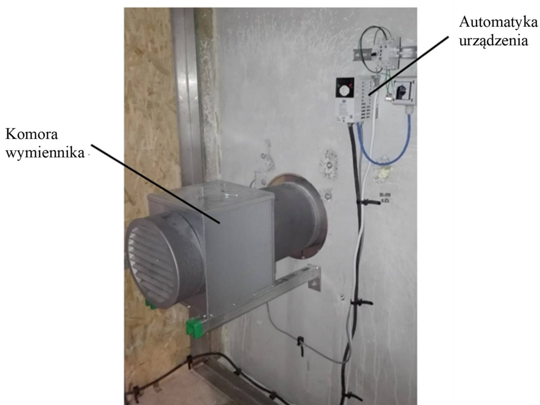
Rys. 31. Urządzenie do wentylacji fasadowej (widok od strony symulującej warunki środowiska wewnętrznego).
