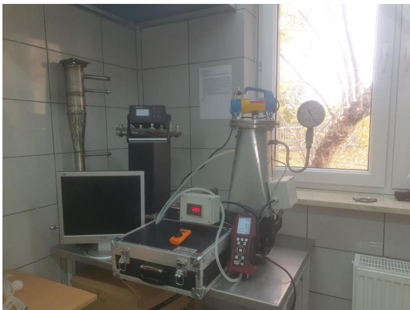
Ryc. 4.5. Eksperymentalna instalacja pirolizy i gazyfikacji (zdjęcie)
