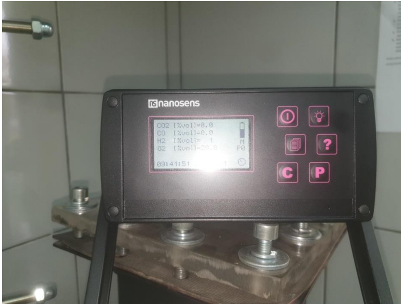
Ryc. 4.15. Przenośny analizator gazu DP-27 CO 2 -CO-H 2 -O 2 – Nanosens
