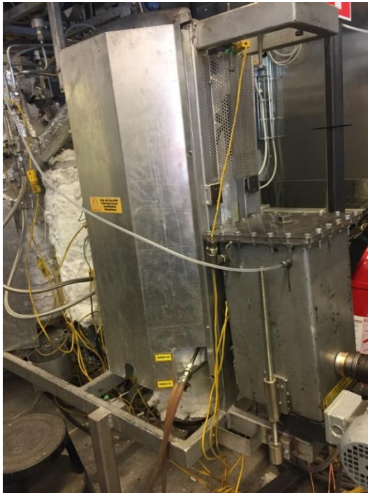
Ryc. 3.2. Napęd przenośnika ślimakowego, komora paliwowa i zespół reaktora
