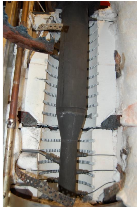
Ryc. 3.3. Reaktor gazogeneratora z grzałkami elektrycznymi
