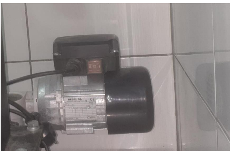
Ryc. 4.12. Silnik elektryczny BIESEL o mocy 180 W (zdjęcie)
