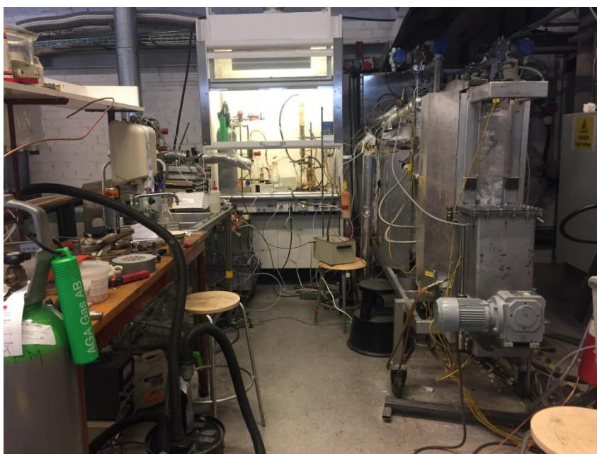
Ryc. 3.1. Widok ogólny instalacji doświadczalnej zgazowania biomasy
